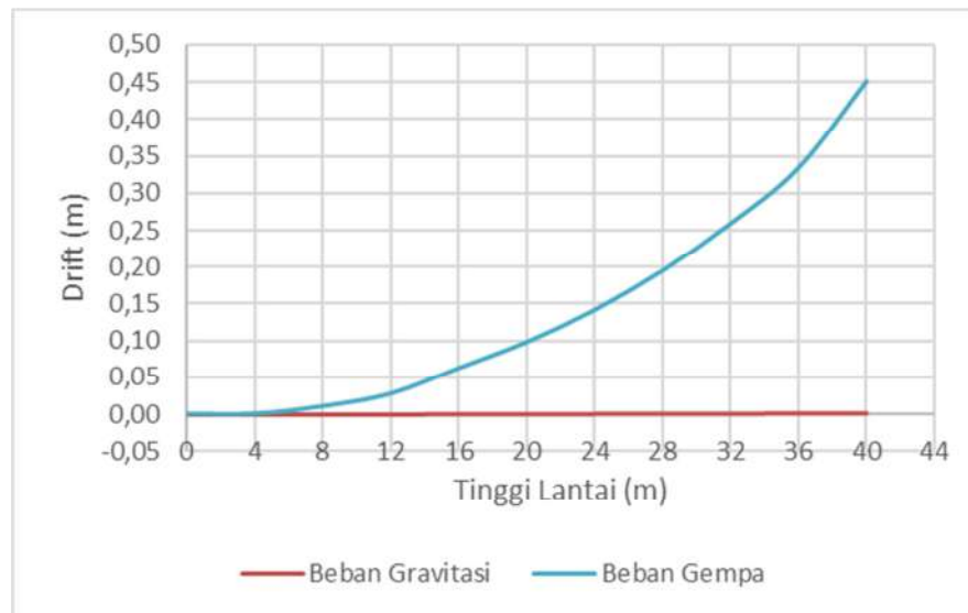
Gambar 8. Grafik hubungan simpangan per lantai dan tinggi lantai akibat beban gravitasi dan gempa aktual terhadap beban gravitasi rencana pada setiap spesimen
