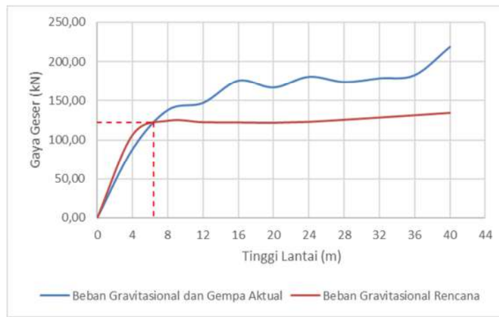
Gambar 6. Grafik hubungan geser tumpuan maksimum pada balok akibat beban gravitasiional dan gempa aktual terhadap beban gravitasiional rencana
