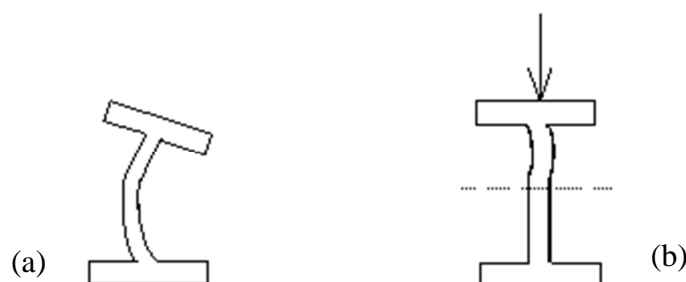
Gambar 2. Lokal buckling pada balok (a) sayap tertekan (b) badan tertekan.
