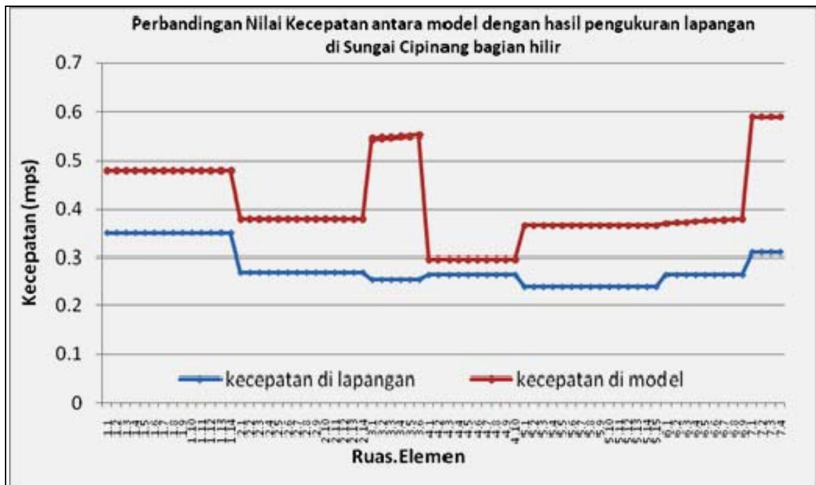
Gambar 5. Perbandingan nilai kecepatan antara model dan hasil pengukuran lapangan
