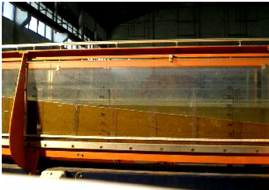
Gambar 8. Profil Kemiringan Pantai Pasir Buatan pada Kondisi awal dengan T=2.5 (kemiringan 1:10)
