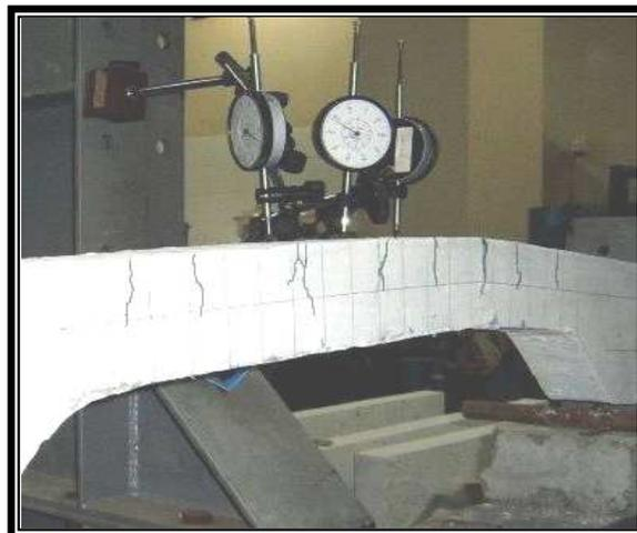
**Gambar 12. Pola dan Jenis Retak Kolom**
